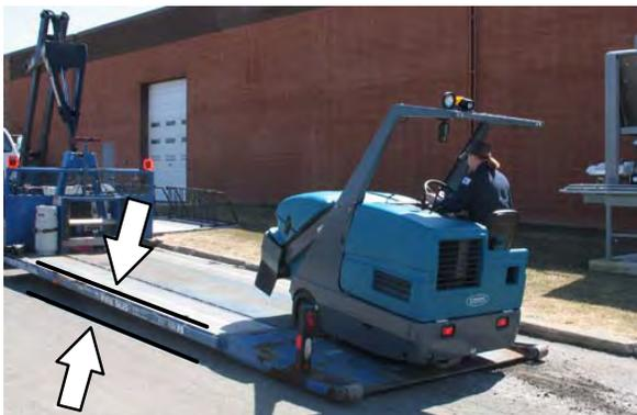
3. トラックまたはトレーラーにウィンチで載せるには、ウィンチのチェーンを後部の固定位置に取り付けます。
