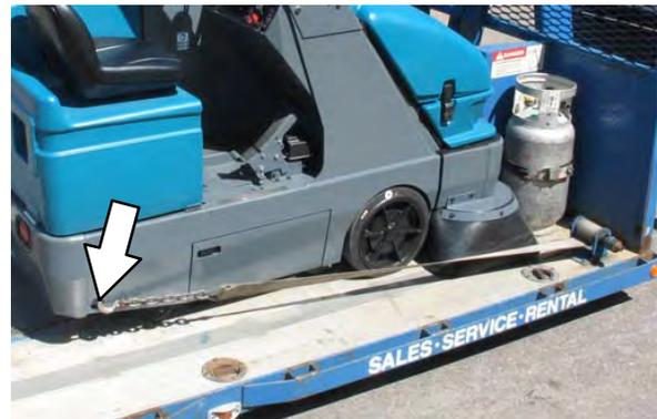
6. 積み込み面が水平でない場合、または地面より380mm以上の高さがある場合、本機の積み降ろしにはウィンチを使用してください。
