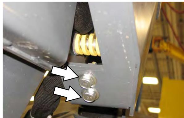
サイドブラシの前後方向チルトは、サイドブラシケーブルと方向U字ピンで調整します。
