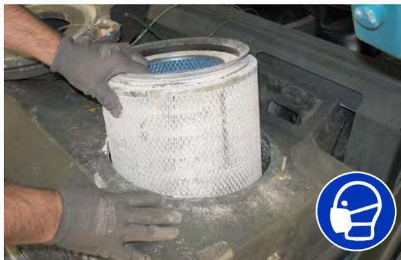
4. ダストフィルターエレメントを清掃するか、または廃棄します。「ダストフィルターの清掃」を参照してください。
