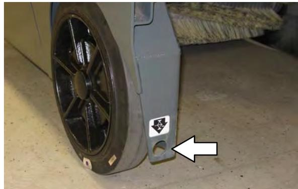
本機フレームの側面のリヤバンパー付近に、後部の固定位置用の穴があります。
