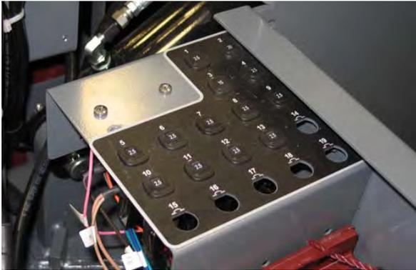
サーキットブレーカーが作動する原因となった過負荷が解消されていない場合、サーキットブレーカーは負荷がなくなるまで電流を遮断し続けます。
