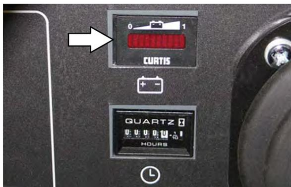
バッテリーが完全に充電されると、インジケータの右端が点灯します。
